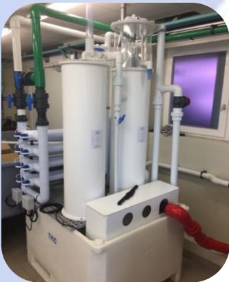
Process aquacole avec filtration biologique et mécanique, refroidissement, réseau air lift, traitement UV Lycée de la Mer et du Littoral Bourcefranc (17)
